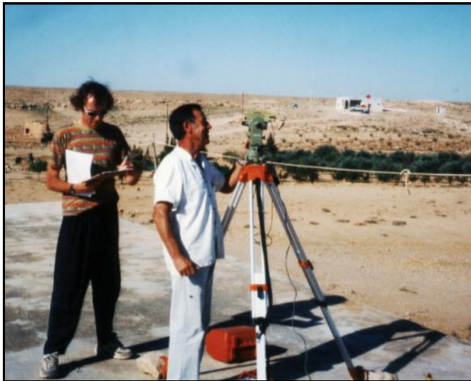
Sur le toit de notre logement, Lucas Martin note les mesures que je fais avec mon vieux T2 non électronique.
