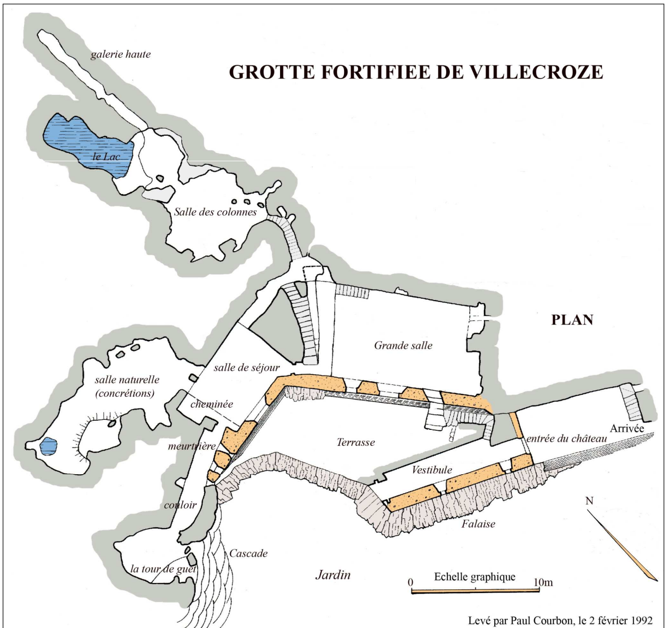
Fig. 7 : Sur le plan, les meurtrières situées sous les fenêtres de la grande salle n'apparaissent pas. Il en est de même pour une salle basse située sous la salle de séjour et ayant les mêmes dimensions. En gris, la paroi rocheuse
