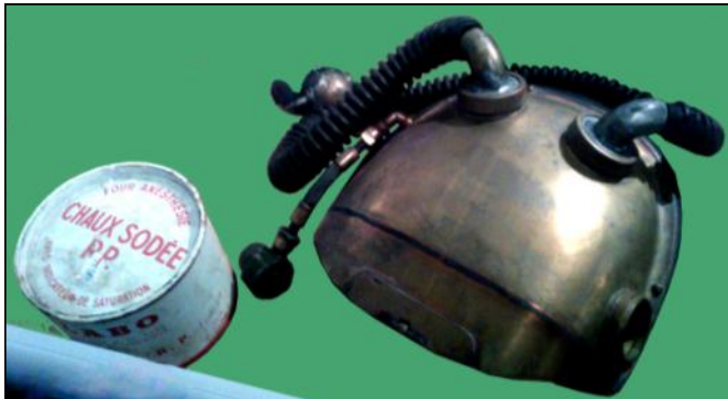
En haut, un vieux recycleur et sa boîte de soude! En bas, Un recycleur russe d'entre les deux guerres.
